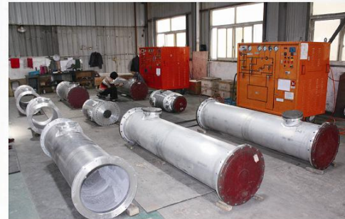
SF6压力测试 Pressure Test
